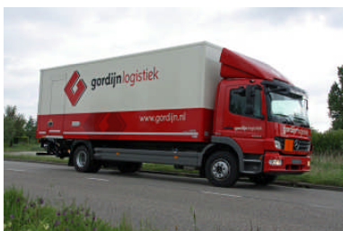
Afbeelding 2 – Afgeronde hoeken zonder boutverbindingen geven een modern design.
